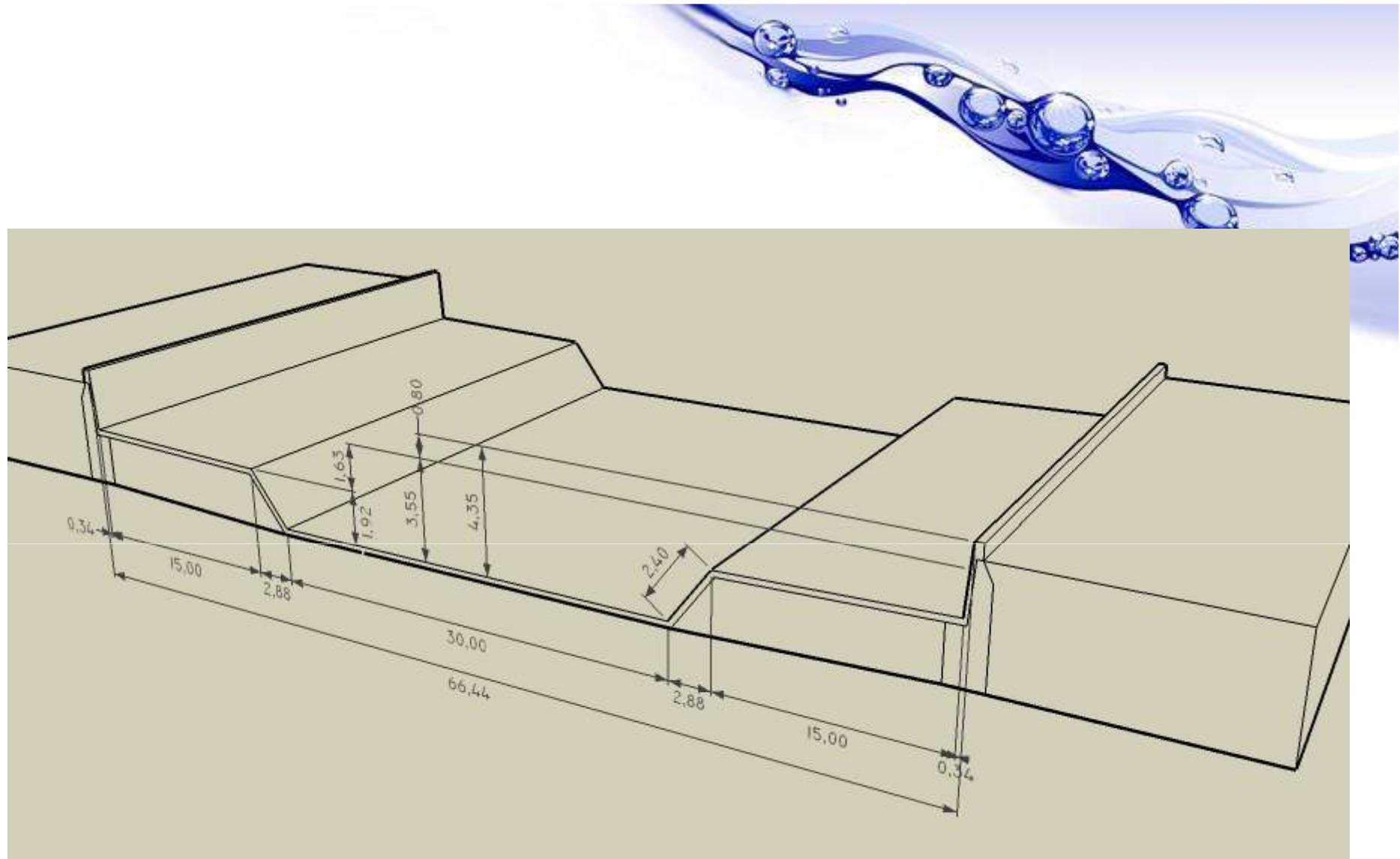
**Попречен пресек на коритото на
